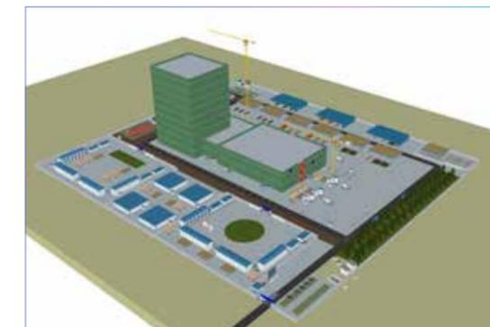
图6 BIM施工场地规划模型
