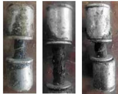
图2 BFRP筋受压试件的破坏模式
